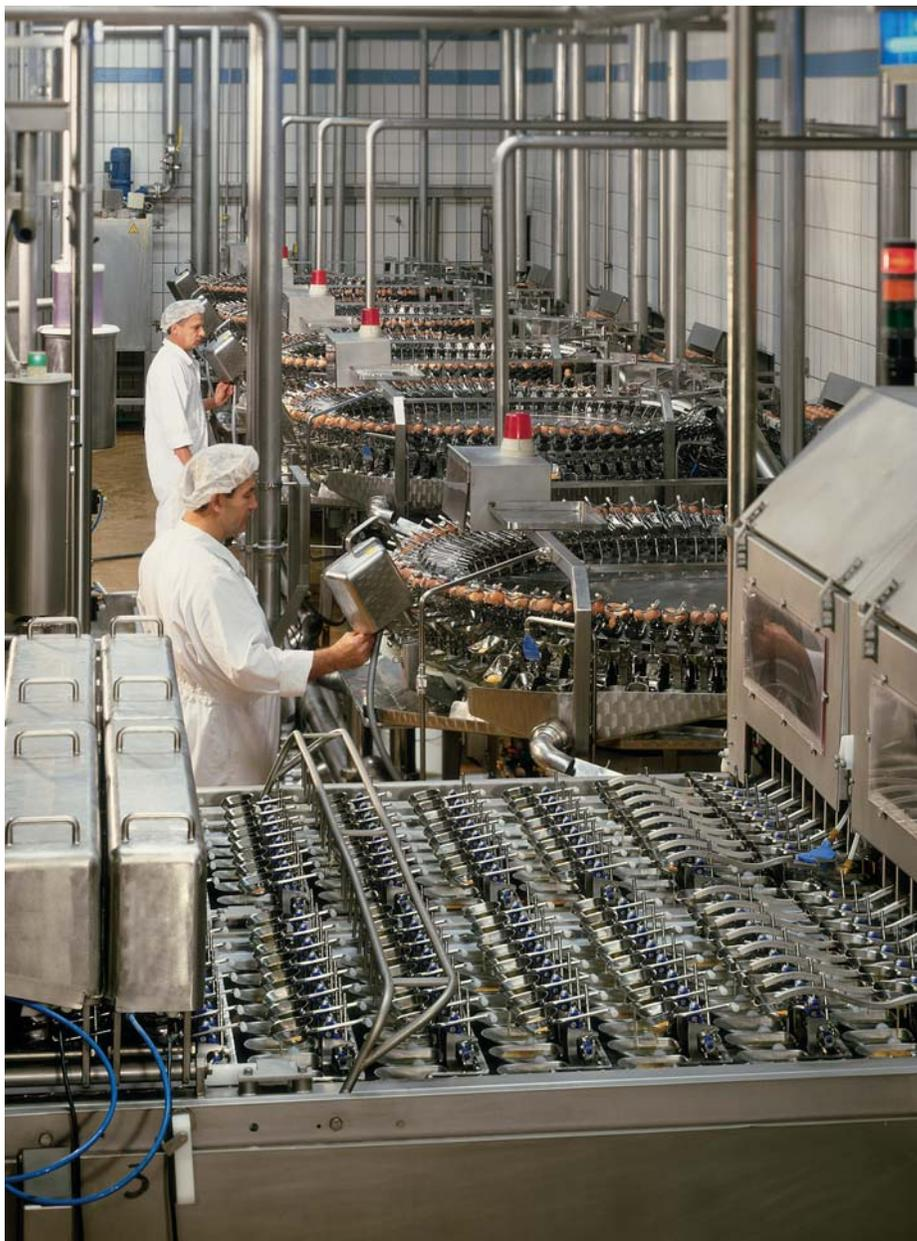
**180.000 Eier in der Stunde:** Im ersten Verarbeitungsschritt werden die bei Ovobest angelieferten Eier von einer vollautomatischen Eiaufschlag- und Trennmaschine bei rasender Geschwindigkeit aufgeschlagen und erstaunlich präzise von der Schale befreit.
